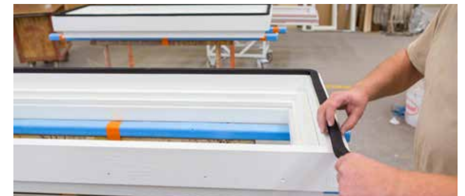
Prefab montage van de Celdex Stelkozijnband op een houten stelkozijn.
